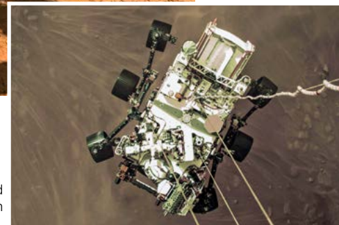
Der Rover «Perseverance» wird vom Raketenschlitten auf den Marsboden abgeseilt.
