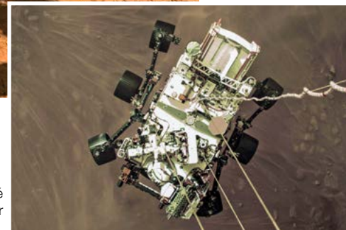
Le rover «Perseverance» est gruté jusqu'à la surface de Mars par l'astromobile.
